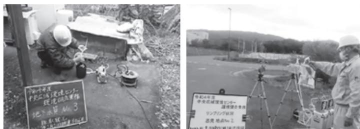
※環境調査は業者により測定を行っています。上の左側の写真は水質調査で、右側の写真は臭気調査の測定を行っている状況です。
