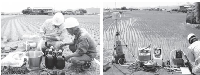
※環境調査は業者により測定を行っています。上の左側の写真は水質調査で、右側の写真は臭気調査の測定を行っている状況です。
